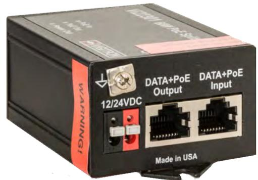
Dieser industrielle PoE-Splitter erlaubt es neben einer IP-Datenschnittstelle mit PoE+ auch eine separate DC Spannung von 12 oder 24VDC zur Verfügung zu stellen. So kann z.B. neben einer PoE-betriebenen IP-Kamera auch eine separate Lichtquelle oder eine separate Heizung gespeist werden. Durch die kleinen Abmessungen und den weiten Bereich der Betriebstemperatur eignet sich das Gerät speziell für den Einbau in Aussenstandorten.
