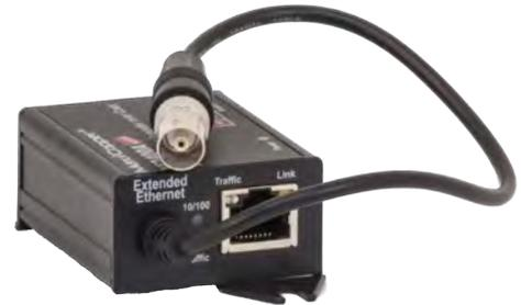
Die Geräte der Serie VI-COAX-24xxA übertragen 10/100Mbps Ethernet und PoE/PoE+ mit Koaxialkabel bis zu einer Distanz von 500m. Die Pass Through Technologie ermöglicht es, die PoE Speisung z.B. eines Midspans direkt über ein Koaxialkabel-Kabel weiterzugeben. Die Geräte brauchen keine Software-Konfiguration. Diagnose LEDs dienen der Übersicht des Betriebszustandes. Die Module der Serie VI-COAX-2400A sind als Tischmodelle, auf Hutschiene und in 19"-Schränken montierbar.
